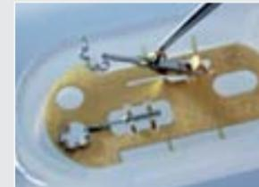
Le Thermo-Dummy® est soulevé à l'aide d'un instrument fin (crochet) et amené en position verticale.
