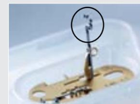
Le laser chirurgical est appliqué sur le Thermo-Dummy® et les valeurs de réglages sont déterminées.
